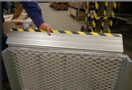
3. Monter la partie supérieure (ÖL) dans la fente sur la moitié supérieure de la rampe. Aucune fixation nécessaire
