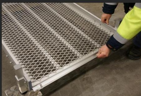
5. Montez la fixation de la rampe (KRL) dans la fente de la partie inférieure de la rampe (idem lorsqu'elle vient...
