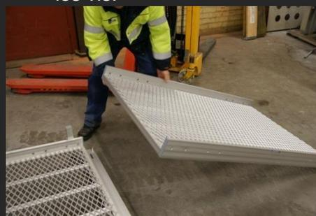
6. Déposez la section de rampe suivante. Répétez 45 jusqu'à la longueur désirée
